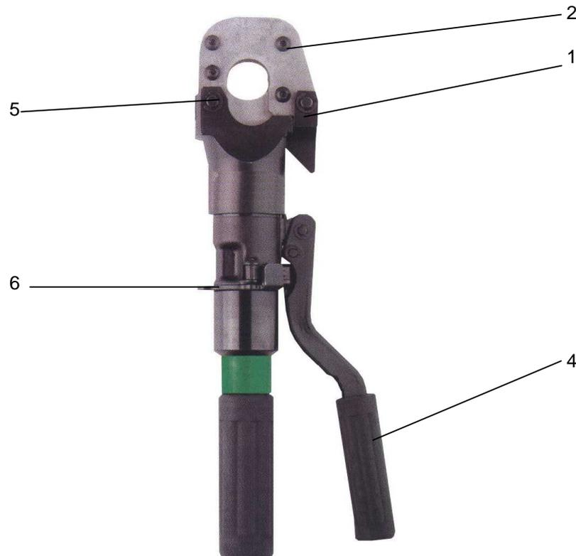
Der Handschneider HS-25-ST wird von uns betriebsbereit geliefert. Durch anheben des Hebels (1) den Klappverschluß/Gegenmesser (2) öffnen. Geöffneten Schneidkopf rechtwinklig an das zu schneidende Kabel anlegen, den Klappverschluß (2) schließen und den Hebel (1) einrasten lassen.
